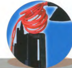
电视机变压器 The TV transformer
